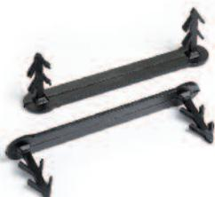
Cavallotto per il semplice ancoraggio manuale del tubo Pe-Xa17 al pannello isolante fissandolo sulle bugne; la parte piana assicura un robusto e vincolante ancoraggio del tubo senza il rischio che possa sollevarsi.
