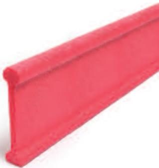
Il giunto, come da prescrizione della norma DIN 18560 e UNI EN 1264, ha lo scopo di permettere la dilatazione del massetto in base al progetto esecutivo. Indicativamente la superficie massima di massetto tradizionale continuo non dovrebbe superare i 40 mq e la lunghezza di 8 m, superate queste misure è bene valutare l'utilizzo del giunto di dilatazione in base allo studio del caso specifico
