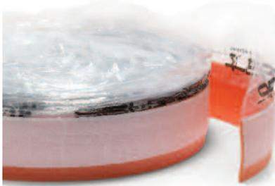
Striscia in polietilene espanso a cellule chiuse, fornito in rotoli di 50 m di lunghezza, altezza 130 mm con adesivo sul retro per 100 mm, e nylon da 300 mm da sovrapporre al pannello isolante. La striscia permette la dilatazione termica del massetto oltre a contribuire ad isolarlo termicamente e acusticamente dai muri perimetrali.
