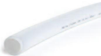
Tubazione PE-Xa 17x2 mm in polietilene reticolato, prodotta secondo il metodo UAX con reticolazione minima pari al 70% effettuata direttamente in fase di estrusione per garantire l'uniformità del grado di reticolazione su tutta la massa del tubo stesso; infatti i perossidi necessari per innescare la reticolazione vengono aggiunti quando il tubo è ancora sufficientemente caldo, prima che si formi la parte cristallina.
