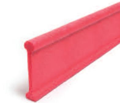
Il giunto, come da prescrizione della norma DIN 18560 e UNI EN 1264, ha lo scopo di permettere la dilatazione del massetto in base al progetto esecutivo. Indicativamente la superficie massima di massetto tradizionale continuo non dovrebbe superare i 40 mq e la lunghezza di 8 m, superate queste misure è bene valutare l'utilizzo del giunto di dilatazione in base allo studio del caso specifico
