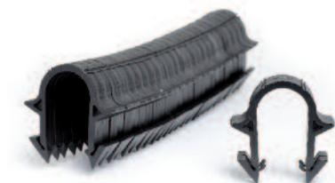
Clip di fissaggio termosaldato per l'ancoraggio in automatico del tubo Pe-Xa 17x2 mm al pannello isolante nella posizione e con l'interasse prevista nel progetto esecutivo. Le estremità appuntite e uncinata permettono l'inserimento nel pannello e l'ancoraggio senza oltrepassarlo (qualsiasi sia lo spessore del pannello) grazie a una larga base di appoggio per fermare la penetrazione, e senza sfilarsi grazie ai quattro piccoli uncini laterali.
