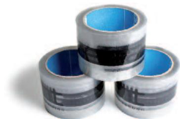
Nastro in polipropilene PPL con collante Hot Melt per la giunzione dei pannelli isolanti. Viene utilizzato sulle teste e sui bordi tagliati del pannello isolante EASY per evitare infiltrazioni di massetto e conseguente formazione di ponti termici e acustici fra massetto e solaio come prescritto dalla norma UNI EN 1264-4.
