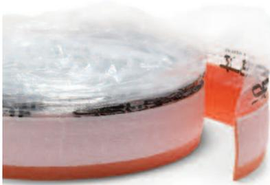
Striscia in polietilene espanso a cellule chiuse, fornito in rotoli di 50 m di lunghezza, altezza 130 mm con adesivo sul retro per 100 mm, e nylon da 300 mm da sovrapporre al pannello isolante. La striscia permette la dilatazione termica del massetto oltre a contribuire ad isolarlo termicamente e acusticamente dai muri
