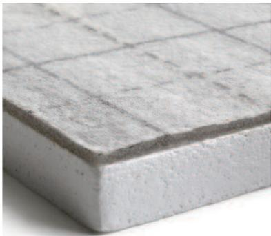
Il Pannello in Polistirene Espanso Sinterizzato è autoestinguento, fornito in rotoli da 10 m di lunghezza e viene accoppiato ad uno speciale tappetino per l'aggancio del tubo con una serigrafia su tutta la superficie per individuare rapidamente il passo di posa (minimo 50 mm).
