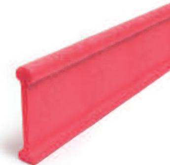
Il giunto, come da prescrizione della norma DIN 18560 e UNI EN 1264, ha lo scopo di permettere la dilatazione del massetto in base al progetto esecutivo. Indicativamente la superficie massima di massetto tradizionale continuo non dovrebbe superare i 40 mq e la lunghezza di 8 m, superate queste misure è bene valutare l'utilizzo del giunto di dilatazione in base allo studio del caso specifico
