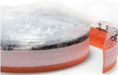
Striscia in polietilene espanso a cellule chiuse, fornito in rotoli di 50 m di lunghezza, altezza 80 mm con adesivo sul retro per tutta la superficie. La striscia permette la dilatazione termica del massetto oltre a contribuire ad isolarlo termicamente e acusticamente dai muri perimetrali. Dopo l'asciugatura del massetto e la
