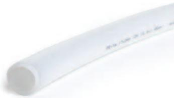
Tubazione PE-Xa 17x2 mm in polietilene reticolato, prodotta secondo il metodo UAX con reticolazione minima pari al 70% effettuata direttamente in fase di estrusione per garantire l'uniformità del grado di reticolazione su tutta la massa del tubo stesso; infatti i perossidi necessari per innescare la reticolazione vengono aggiunti quando il tubo è ancora sufficientemente caldo, prima che si formi la parte cristallina.
