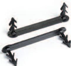
Cavallotto per il semplice ancoraggio manuale del tubo Pe-Xa17 al pannello isolante fissandolo sulle bugne; la parte piana assicura un robusto e vincolante ancoraggio del tubo senza il rischio che possa sollevarsi.
