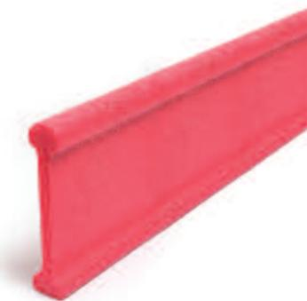
Il giunto, come da prescrizione della norma DIN 18560 e UNI EN 1264, ha lo scopo di permettere la dilatazione del massetto in base al progetto esecutivo. Indicativamente la superficie massima di massetto tradizionale continuo non dovrebbe superare i 40 mq e la lunghezza di 8 m, superate queste misure è bene valutare l'utilizzo del giunto di dilatazione in base allo studio del caso specifico
