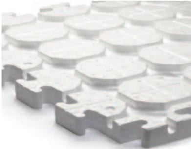
Il pannello DRY14 è realizzato in polistirene espanso (EPS) con bugne di altezza 15 mm pedonabili fra cui vengono inserite le lamelle di alluminio termoconduttrici per l'incastro della tubazione PeXa 14 in base al passo di posa scelto fra 11,5 e 23 cm. I bordi del pannello, su tutti e quattro i lati, sono forniti di pratici incastri per la congiunzione al pannello adiacente.
