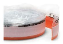
Striscia in polietilene espanso a cellule chiuse, fornito in rotoli di 50 m di lunghezza, altezza 250 mm con adesivo sul retro per tutta la superficie. La striscia permette la dilatazione termica del massetto oltre a contribuire ad isolarlo termicamente e acusticamente dai muri perimetrali. Dopo l'asciugatura del massetto e la
