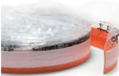
Striscia in polietilene espanso a cellule chiuse, fornito in rotoli di 50 m di lunghezza, altezza 80 mm con adesivo sul retro per tutta la superficie. La striscia permette la dilatazione termica del massetto oltre a contribuire ad isolarlo termicamente e acusticamente dai muri perimetrali.
